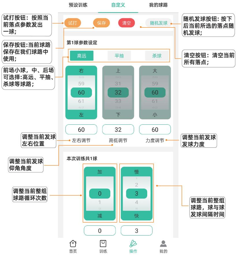
8、自定义:图形界面所示为发球机对面的半片羽毛球场地,在所需落点示意图上长按2秒选择,选择完毕后,点击下方开始即可。
